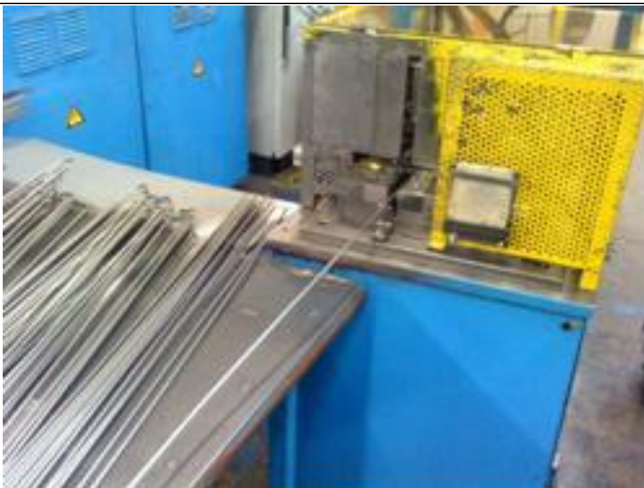
Slika 11 Proizvodna linija za dodelavo cevi – operacija 2: širjenje cevi
