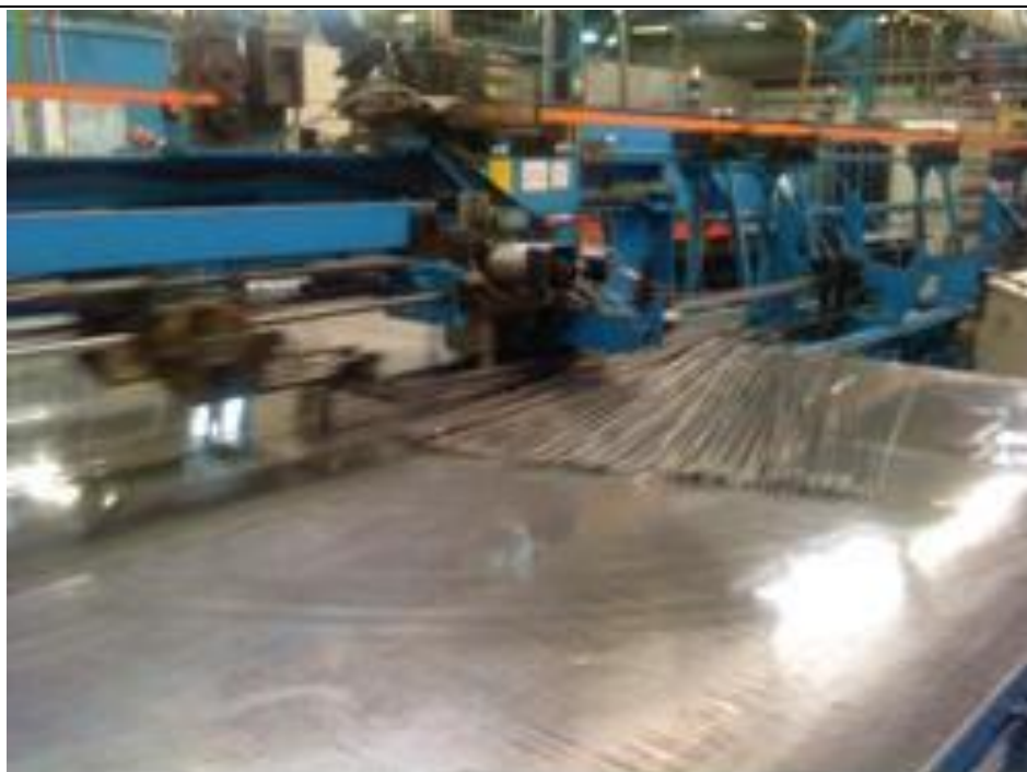
Slika 12 Proizvodna linija za dodelavo cevi – operacija 3: ožanje cevi
