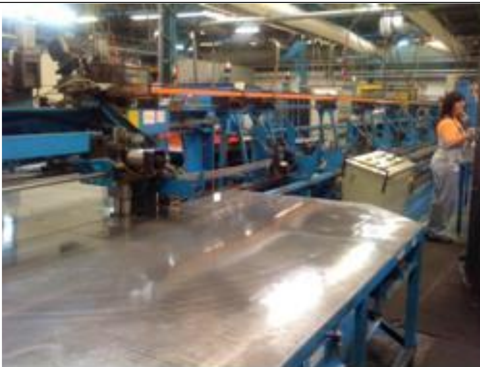
Slika 10 Proizvodna linija za dodelavo cevi – operacija 1: razigljenje cevi
