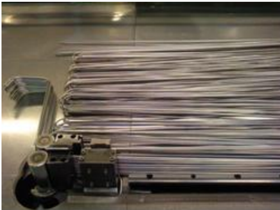
Slika 14 Proizvodna linija za dodelavo cevi – operacija 5: izpihovanje cevi
