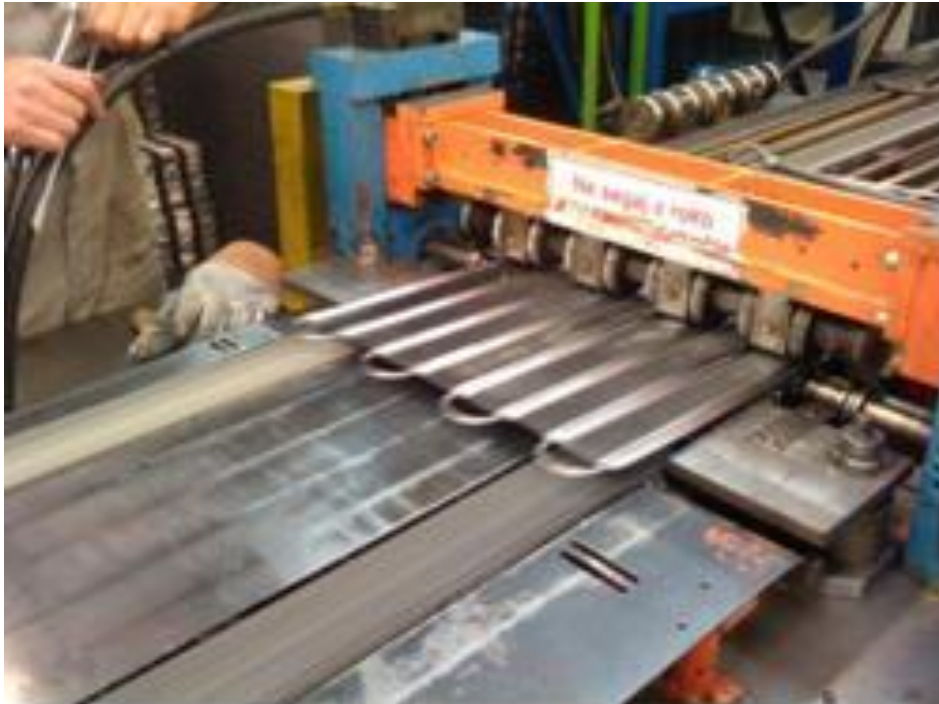
Slika 13 Proizvodna linija za dodelavo cevi – operacija 4: krivljenje končin cevi
