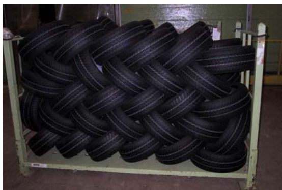
Slika 3.5 Zlaganje potniških avtoplaščev po načinu »ribje kosti«
